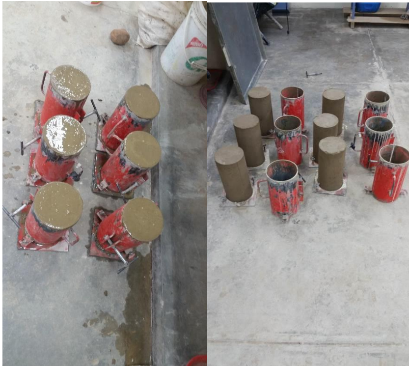
Toma fotográfica N° 12: Elaboración de 6 probetas.
