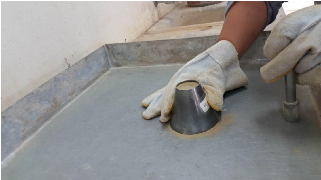
Toma fotográfica N° 7: Verificación de la muestra si se encuentra en estado saturado y seco.
