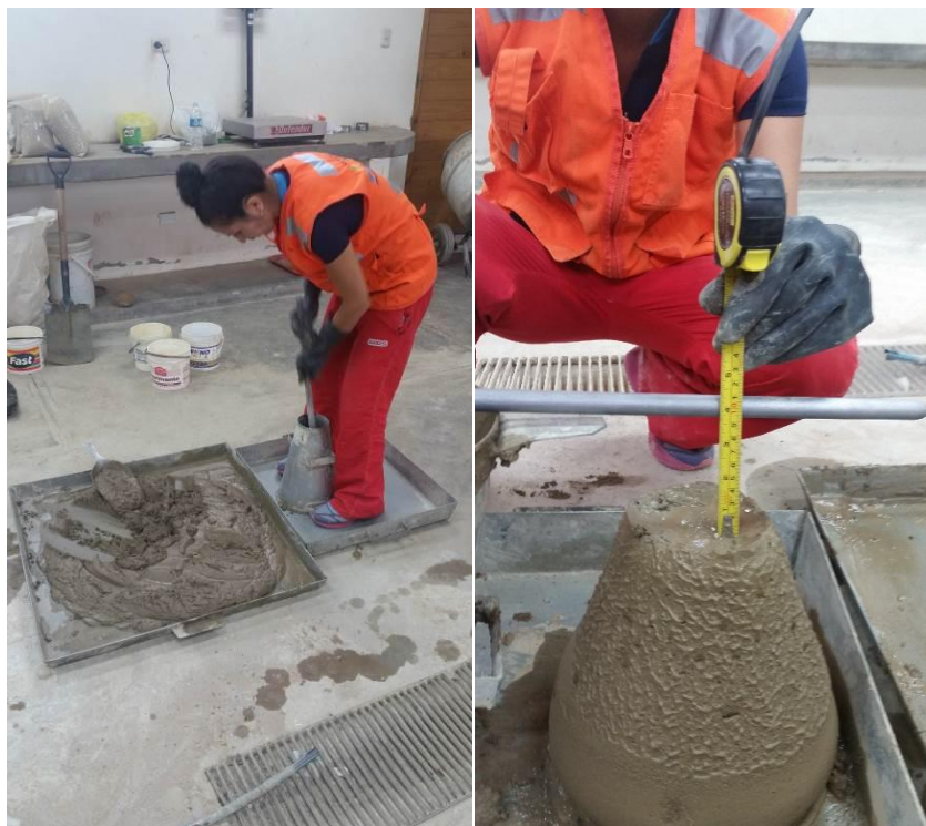
Toma fotográfica N° 11: Ensayo de Slump.
