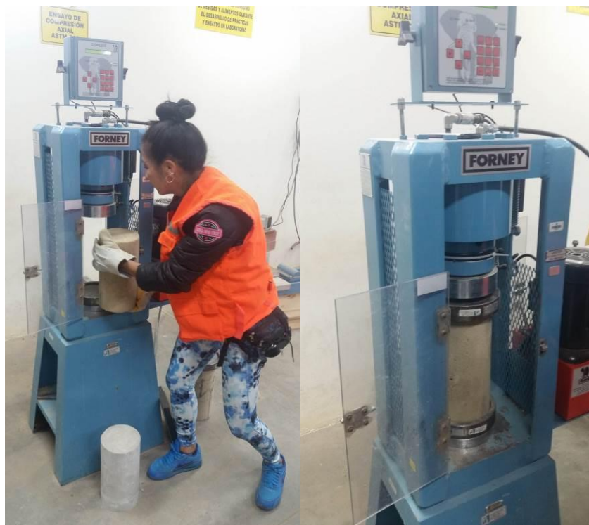
Toma fotográfica N° 14: Ensayo de compresión Axial ASTM C-39.
