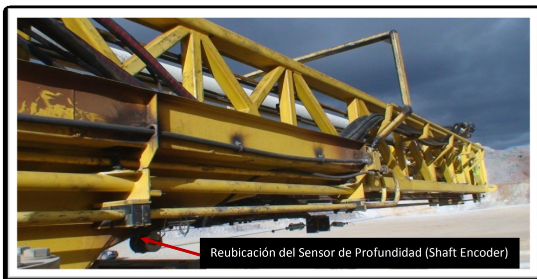
Figura N° 11. Reubicación del sensor de profundidad (Shaft Encoder) de la perforadora Reedrill SKS-12.
