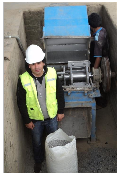
Fotografía N° 04: PVC reciclado seleccionado triturado con tamaño máximo de 1/2"
