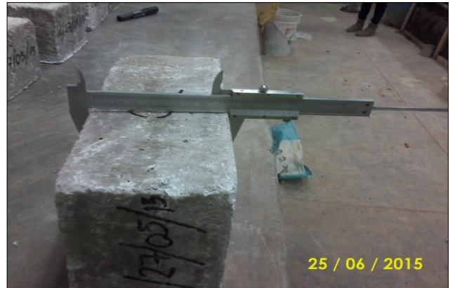
Fotografía N° 29: Toma de medidas de los ladrillos patrones utilizando el vernier
