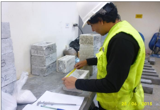
Fotografía N° 28: Toma de medidas de los ladrillos patrones.
