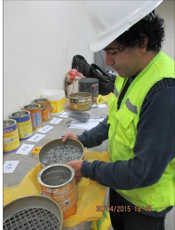
Foto N° 11: Tamizando el PVC triturado por las mallas, para el ensayo de granulometría.
