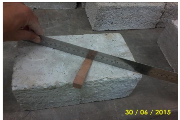
Fotografía N° 31: Toma de convexidad de ladrillos.
