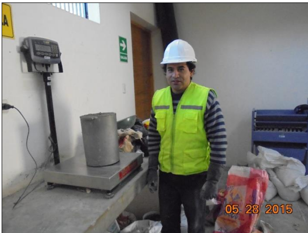
Fotografía N° 22: Peso de recipiente más mezcla de concreto
