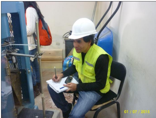
Fotografía N° 38: Toma de datos de deformaciones en los ladrillos
