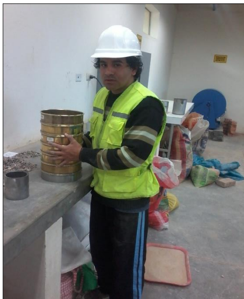
Foto Nº 07: Tamizando el material por las mallas, para el ensayo de granulometría.
