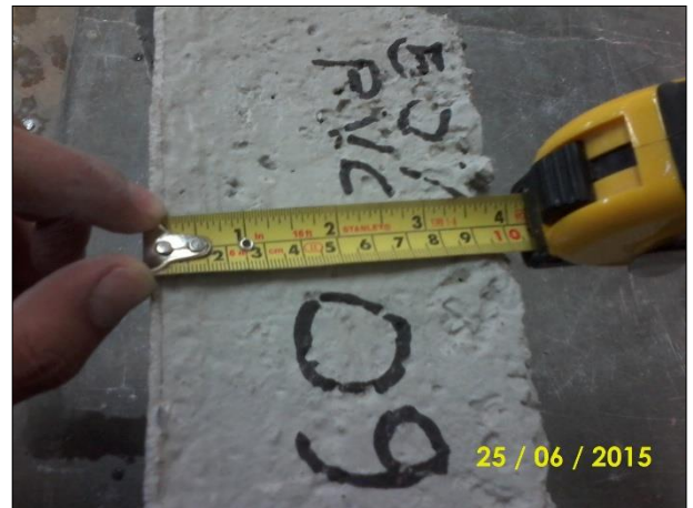
Fotografía N° 33: Medida de 3 mm para el ensayo de capilaridad.
