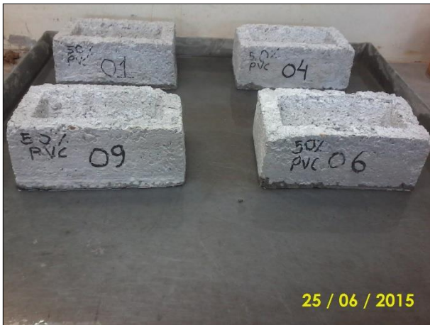
Fotografía N° 32: Capilaridad de ladrillos, tiempo 1 minuto
