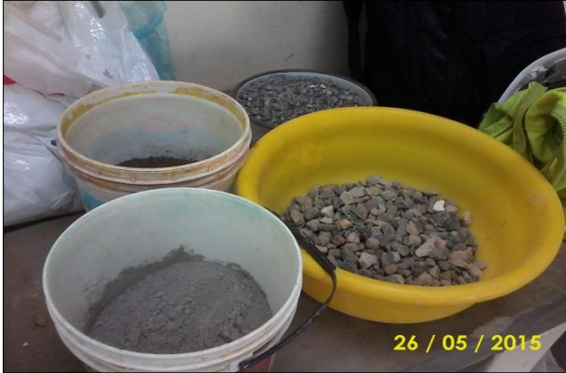
Fotografía N° 20: Cantidades de agregados y cemento para fabricar ladrillos.
