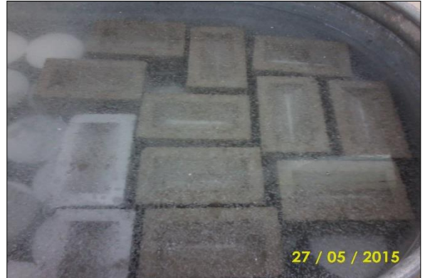
Fotografía N° 27: Curado de los ladrillos en la poza.
