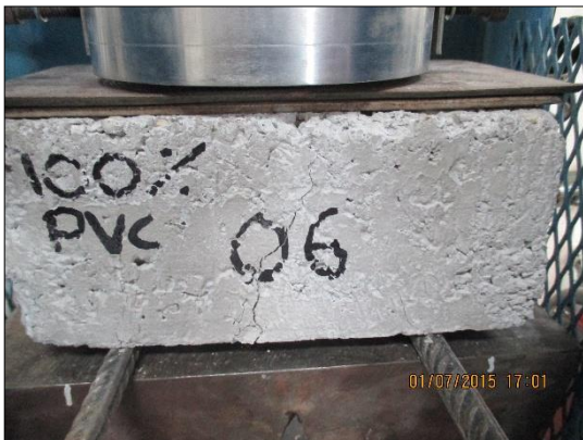
Fotografía N° 44: Ensayo a flexión en ladrillos con 100% de PVC
