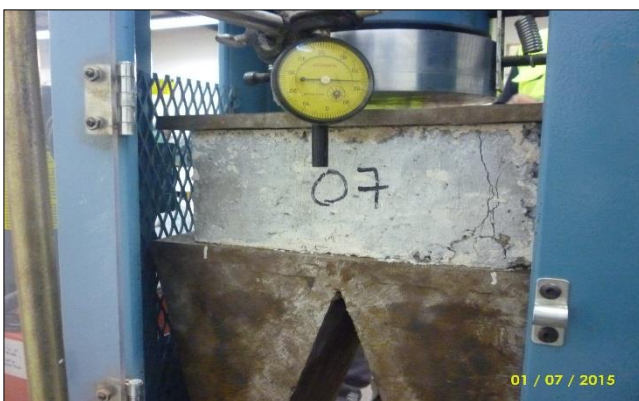
Fotografía N° 40: Carga axial en los ladrillos
