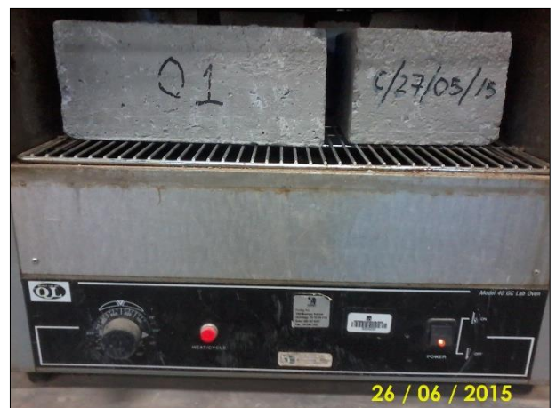
Fotografía N° 35: Ladrillos en horno por 24 horas después de la inmersión
