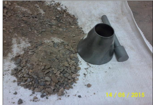
Fotografía N° 15: Humedad libre del agregado fino
