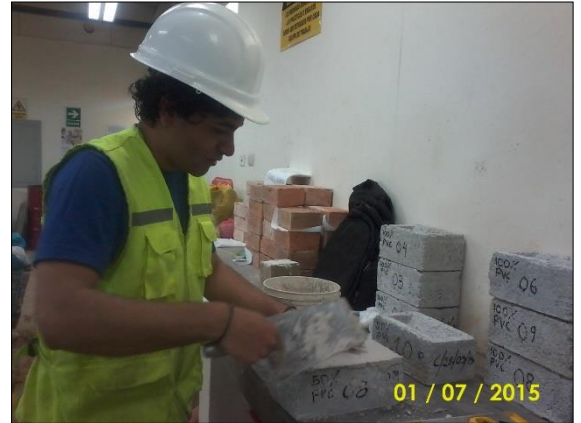
Fotografía N° 37: Refractado de ladrillos con yeso
