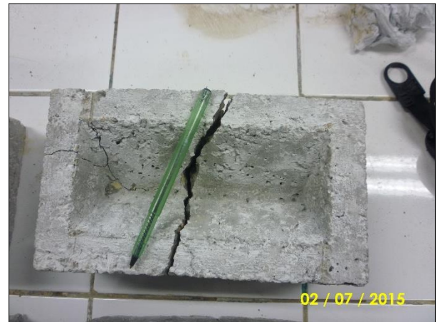
Fotografía N° 47: Espesor de la falla a flexión en ladrillos patrones
