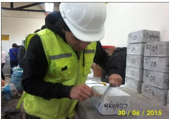
Fotografía N° 30: Toma de medida de convexidad de ladrillos
