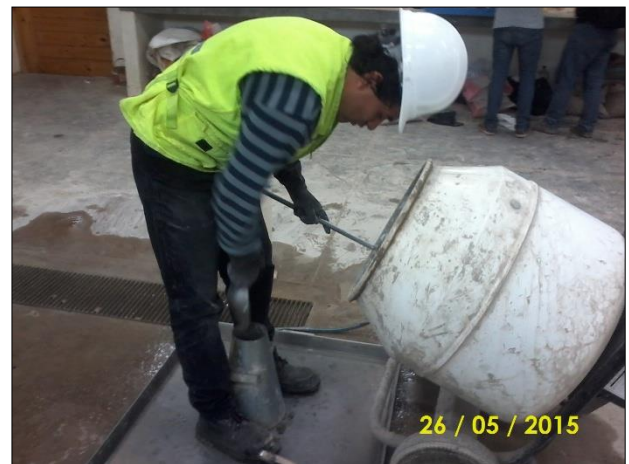
Fotografía N° 23: Prueba de control de consistencia de la mezcla.
