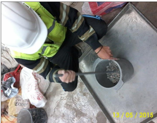
Fotografía N° 12: Peso unitario seco compactado, del agregado grueso.
