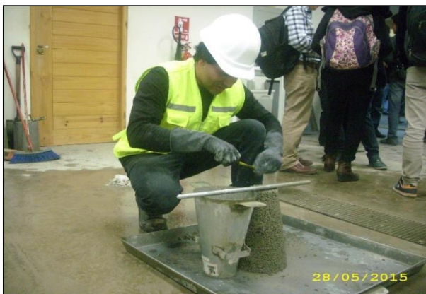
Fotografía N° 24: Medición de slump
