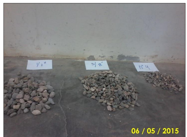
Fotografía Nº 09: Pesos retenidos en las mallas del agregado grueso
