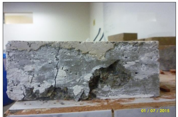
Fotografía N° 41: Falla a compresión de ladrillos patrones
