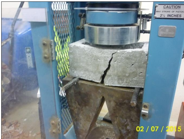
Fotografía N° 46: Falla a flexión de ladrillos patrones.
