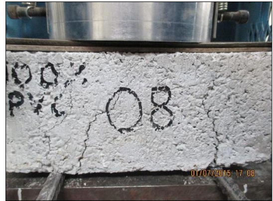
Fotografía N° 45: Falla a flexión de ladrillos con 100% de PVC
