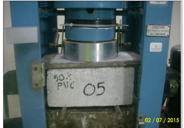
Fotografía N° 43: Ensayo a flexión en ladrillos con 50% de PVC
