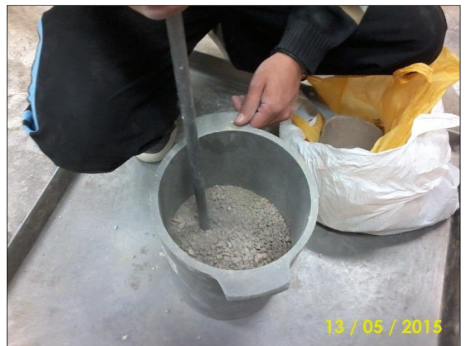
Fotografía N° 13: Peso unitario seco compactado, del agregado fino.
