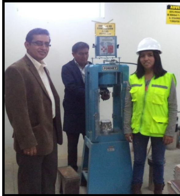
Fig. 47: Equipo empleado para compresión del adobe.
