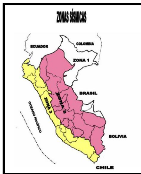
Fig.14. Zonas sísmicas según norma sismoresistente.
