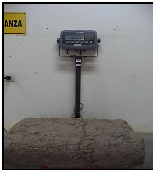
Fig. 53: Determinación del peso específico del adobe
