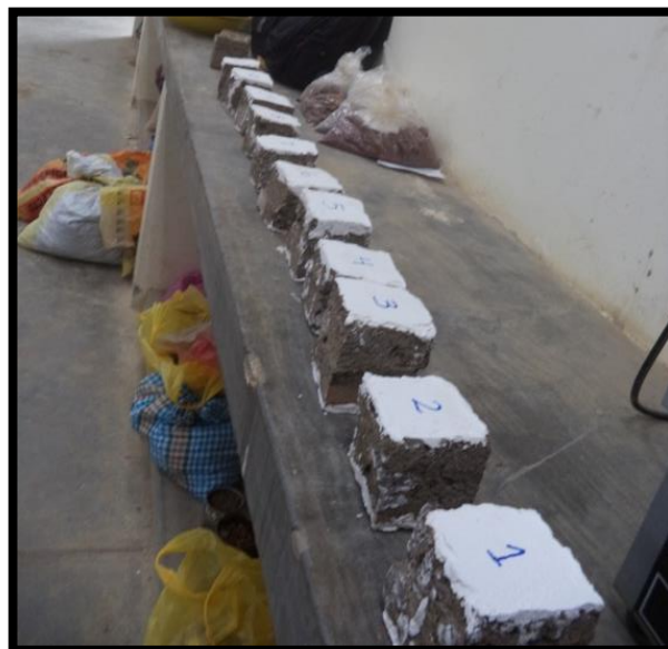
Fig. 50: Adobe para someter a compresión.
