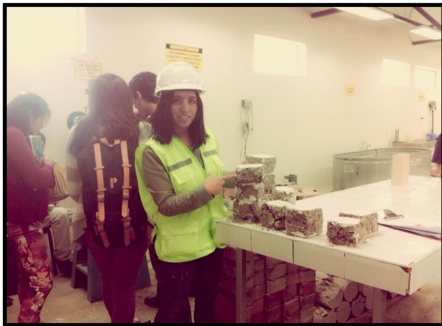
Fig. 51: Muestras de adobe luego de ser ensayados.
