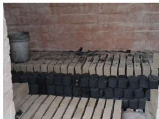
Briquetas de carbon puestas encima de la parrilla armada sobre los Sopletes.
