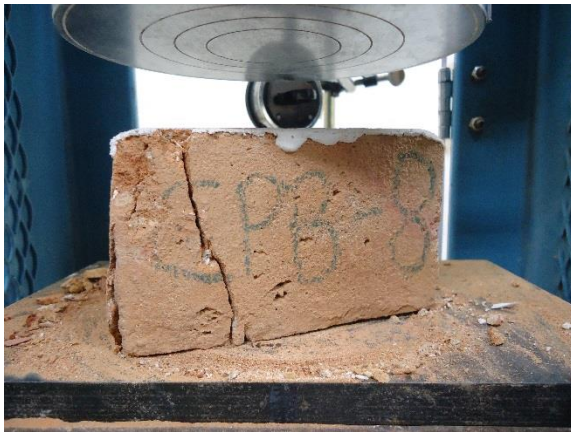
Foto 15. Falla de la ladrillera CPB.
