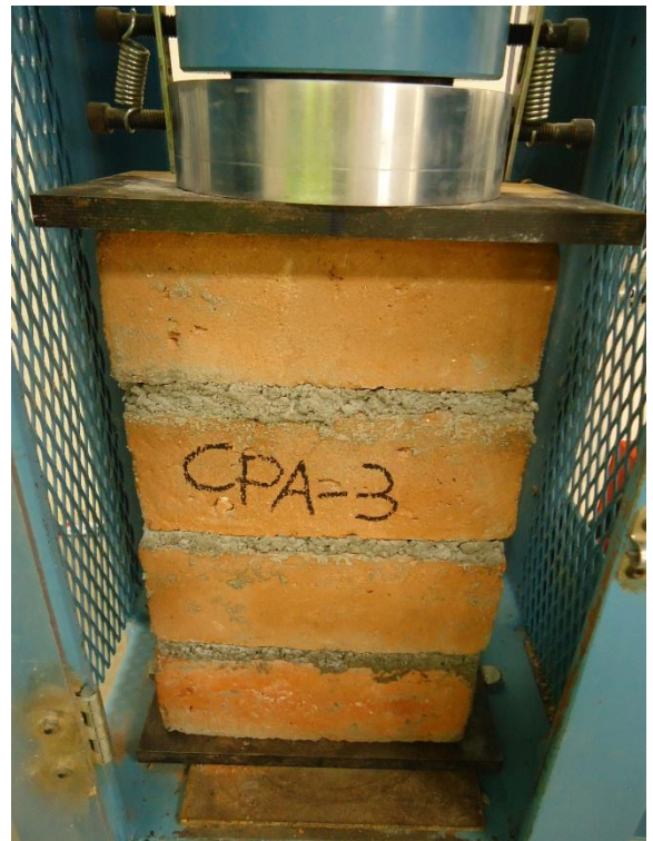
Foto 40. Ensayo de pilas de ladrillera CPA.
