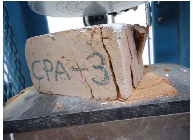
Foto 14. Falla de la ladrillera CPA.
