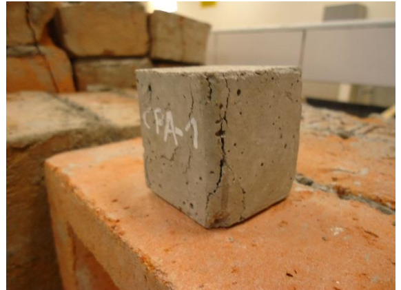
Foto 45. Mecanismo de falla del mortero.
