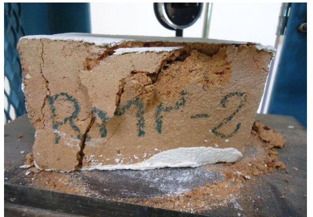
Foto 16. Falla de la ladrillera RMP.
