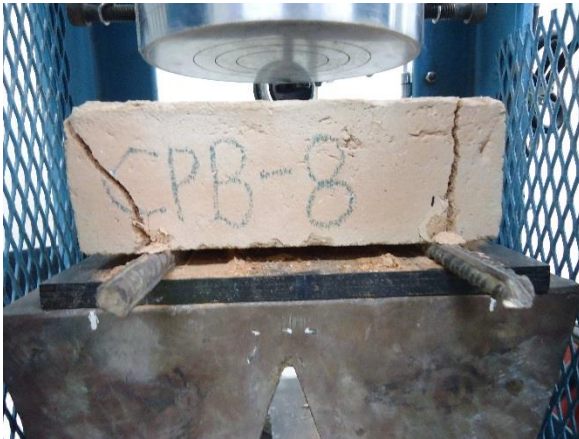
Foto 19. Falla en ensayo a tracción de CPB.
