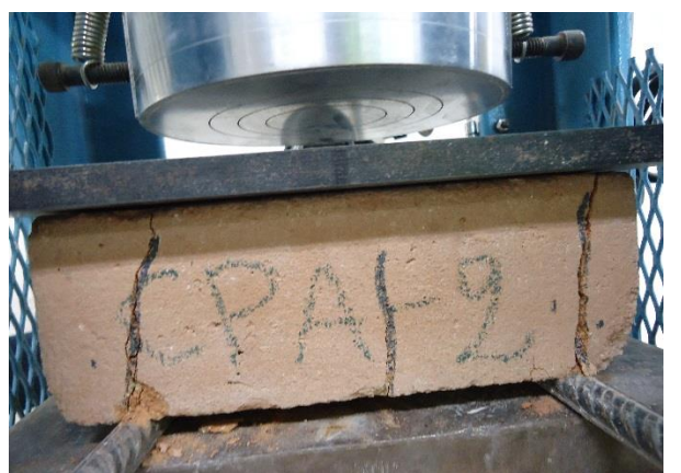
Foto 18. Falla en ensayo a tracción de CPA.
