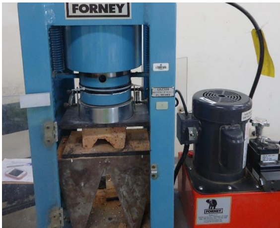
Foto 13. Ensayo a compresión.
