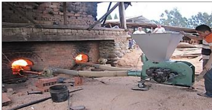
Figura N° 20: Etapa de cocción de los ladrillos.
