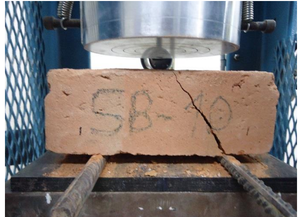
Foto 20. Falla en ensayo a tracción de SB.
