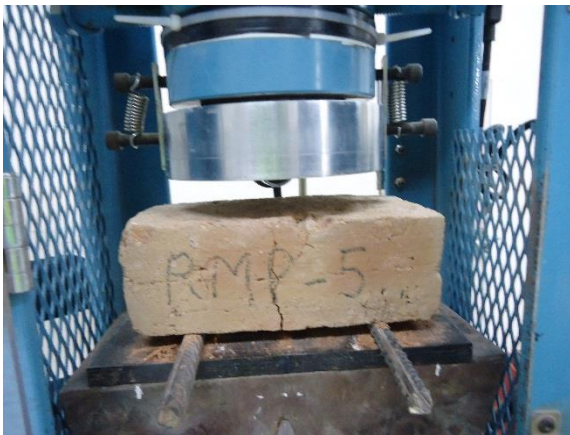
Foto 21. Falla en ensayo a tracción en RMP.
