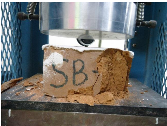
Foto 17. Falla de la ladrillera SB.
