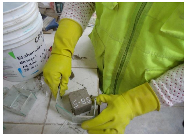
Foto 36. Desmolde de cubos de mortero.
