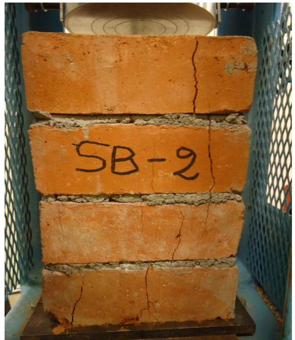
Foto 42. Mecanismo de falla de la pila.
