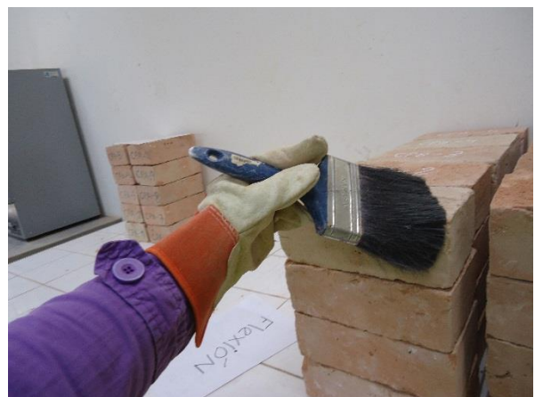
Foto 6. Removiendo partículas de la unidad.
