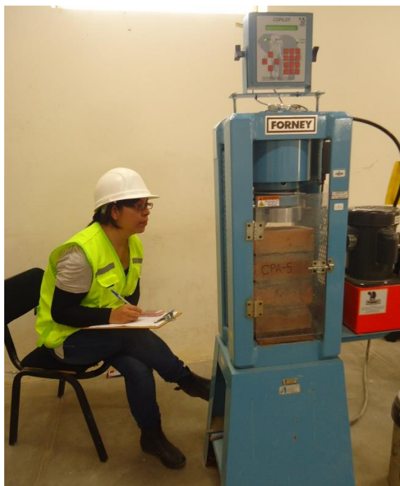
Foto 43. Toma de datos del deformímetro.
