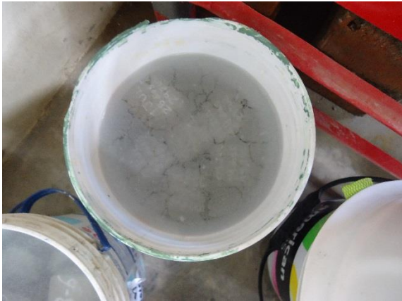
Foto 37. Curado de mortero en agua con cal.
