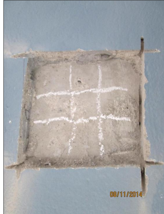
Muestra lista para realizar el ensayo de esclerometría
