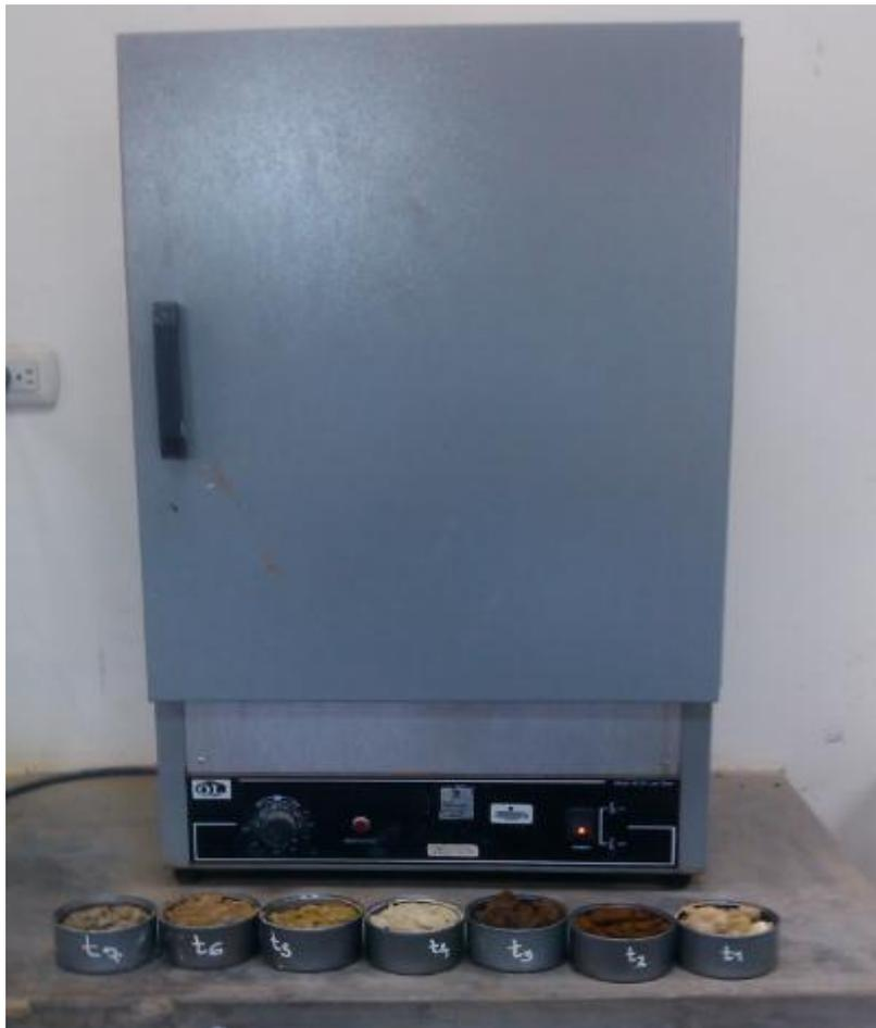
FOTO N ° 8: Muestras para secado en horno, durante 24 h. (Contenido de humedad)
