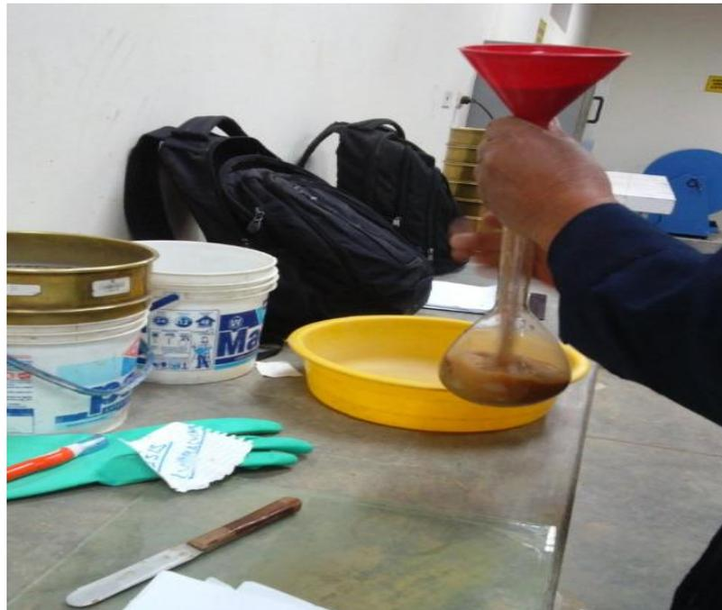
FOTO N ° 12: Colocación de muestra en la fiola (Peso específico).
