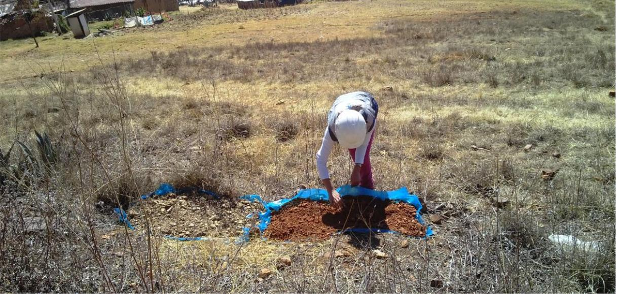
FOTO N ° 7: Secado de muestra a la intemperie.
