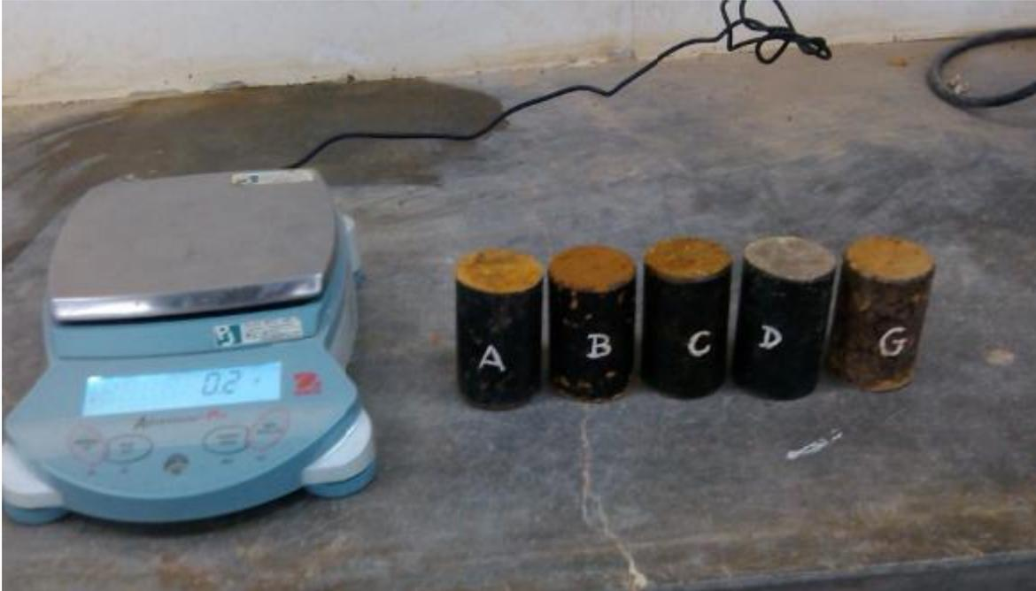
**FOTO N ° 13:** Peso de los cilindros + muestra (Densidad natural).
