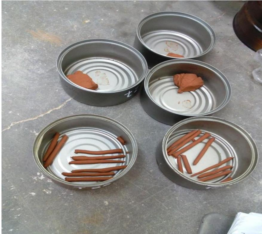
FOTO N ° 11: Muestras extraídas del horno. (Límite Plástico)
