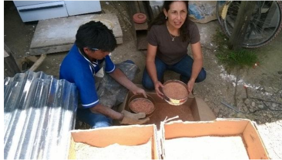
Foto 19. Secado y cernido de aserrín y arena
