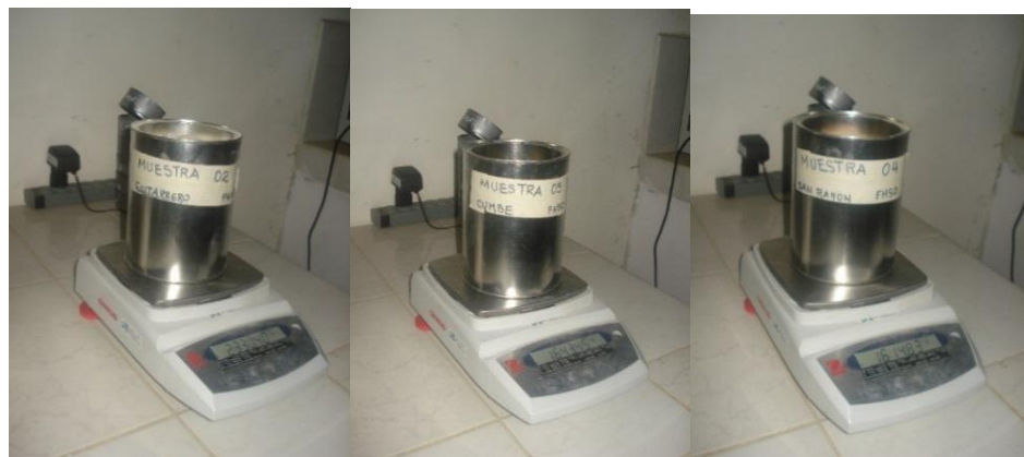
Foto 06. Pesaje de Arcilla Laboratorio de Suelos UPN
