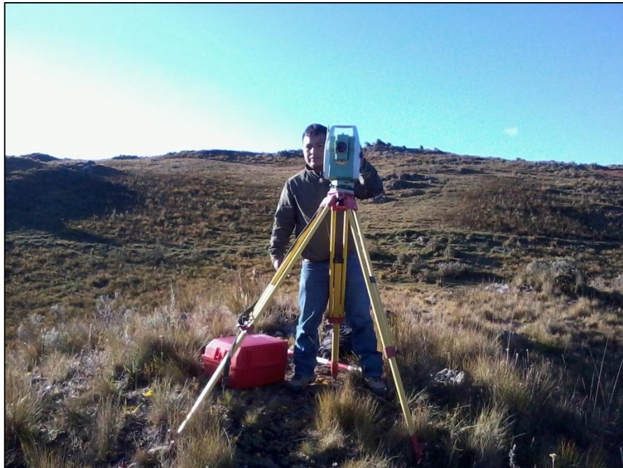
Fotografía N° 6: Estacionamiento de Estación Total para inicio del levantamiento topográfico.
