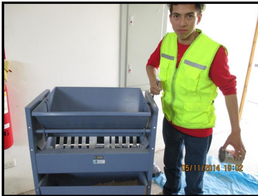
Cuarteo de Muestra de la Calicata N° 01.
