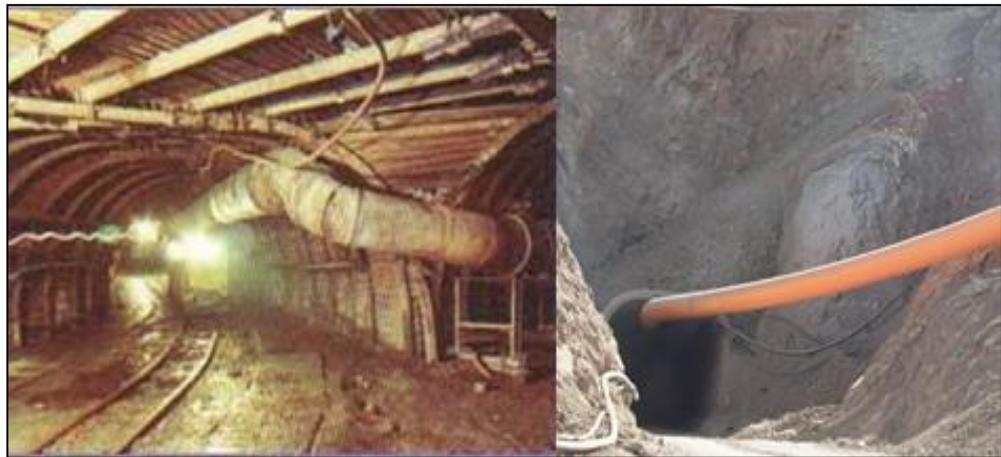
Figura 4.5: Operaciones mineras subterráneas con sus respectivas mangas de ventilación.
