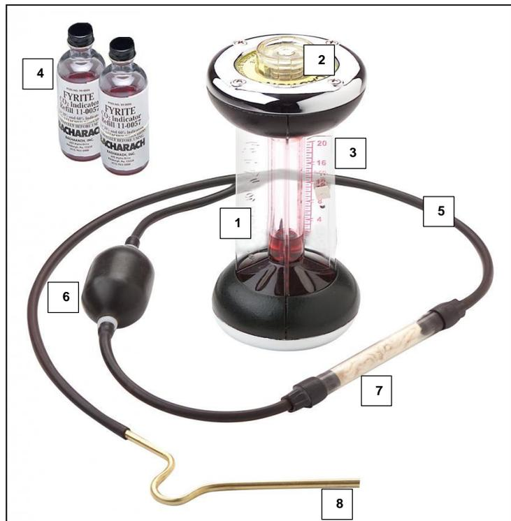
Figura N° 4.2. Equipo Fyrite.
