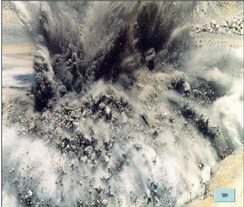
Figura N° 3.8. Excesivo lanzamientos de fragmentos de rocas.
