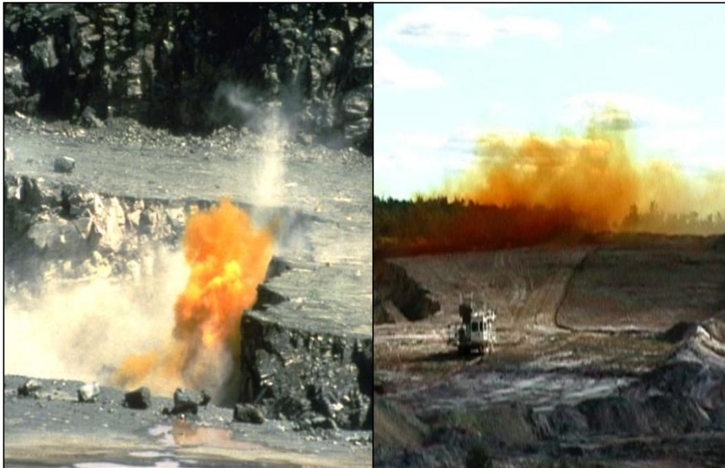
Figura N° 4.1. Generación de gases tóxicos al detonar una mezcla explosiva comercial.
