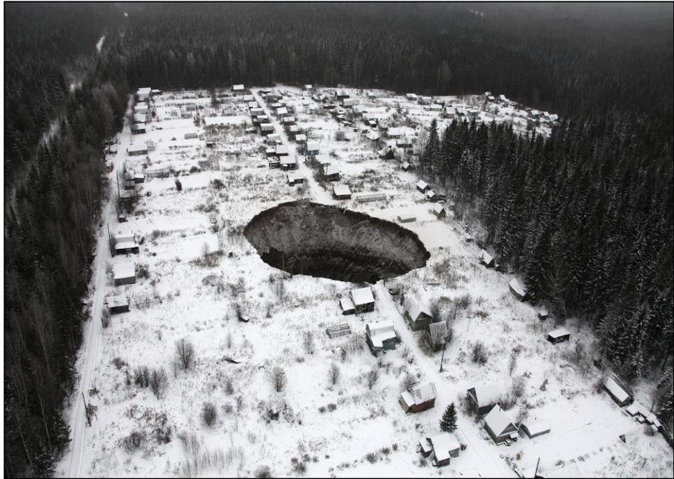
Figura N° 3.11. Efecto de la subsidencia en el suelo (Mina de Potasio
