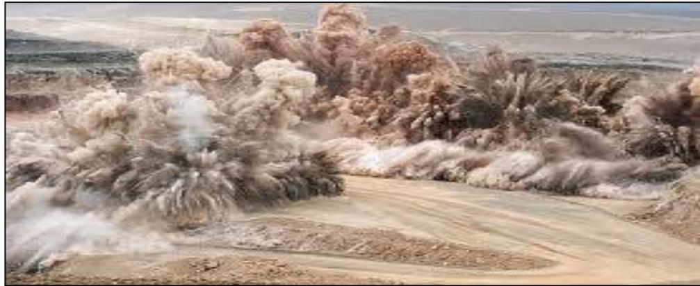
Figura N° 4.6: Operación minera unitaria de voladura de rocas en un tajo abierto.
