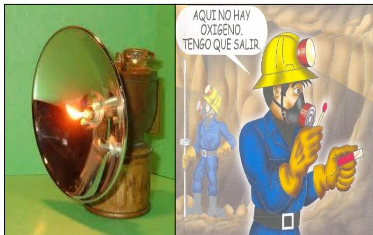
Figura N° 4.1. Lámpara de Carburo y técnica del fósforo para detectar la falta de oxígeno en una mina subterránea.
