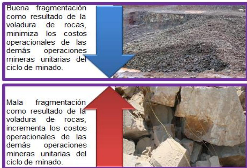
Figura N° 5.1. Fragmentación como resultado de una voladura de rocas.
