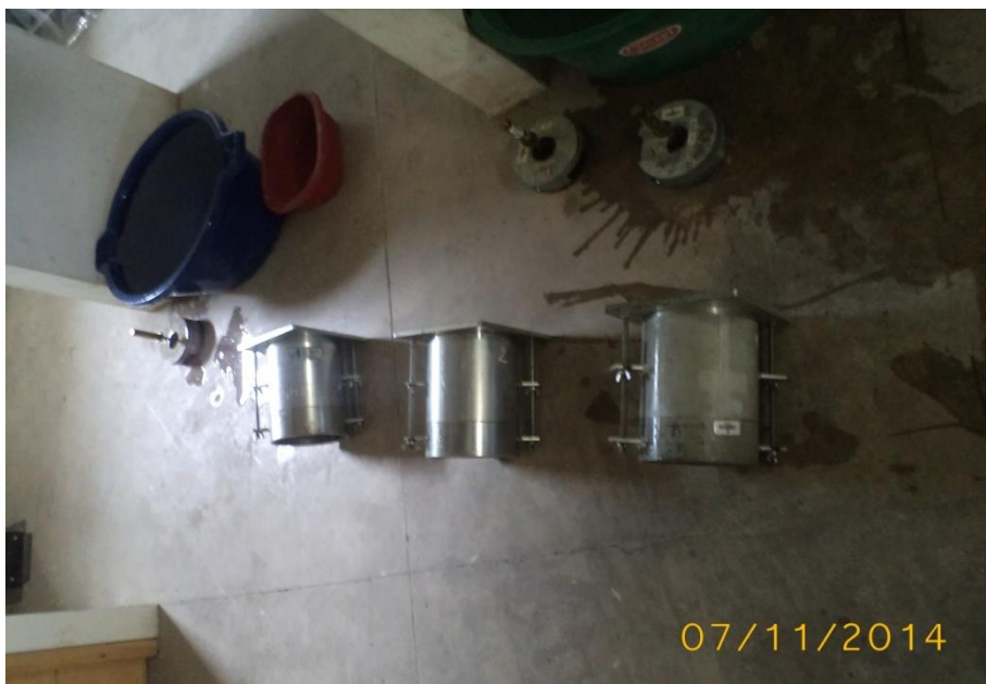
FOTO 30: muestras colocadas en forma horizontal por 15 min para luego realizar el ensayo de penetración
