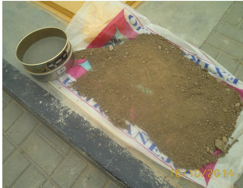
FOTO 07: Secando al aire la muestra obtenida de las calicatas y tamizando
