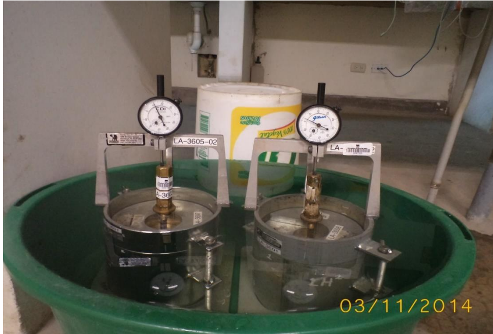
FOTO 27: Muestras de CBR sumergidas en el agua por 96 horas
