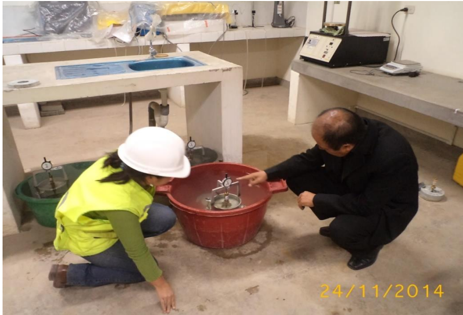
FOTO 29: lectura de la deformación de la muestra en el ensayo de CBR de hinchamiento
