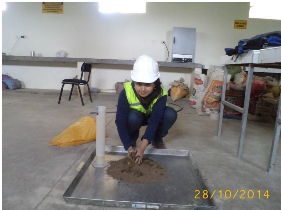
FOTO 14: Mezclando la muestra con un porcentaje de agua para el proctor modificado
