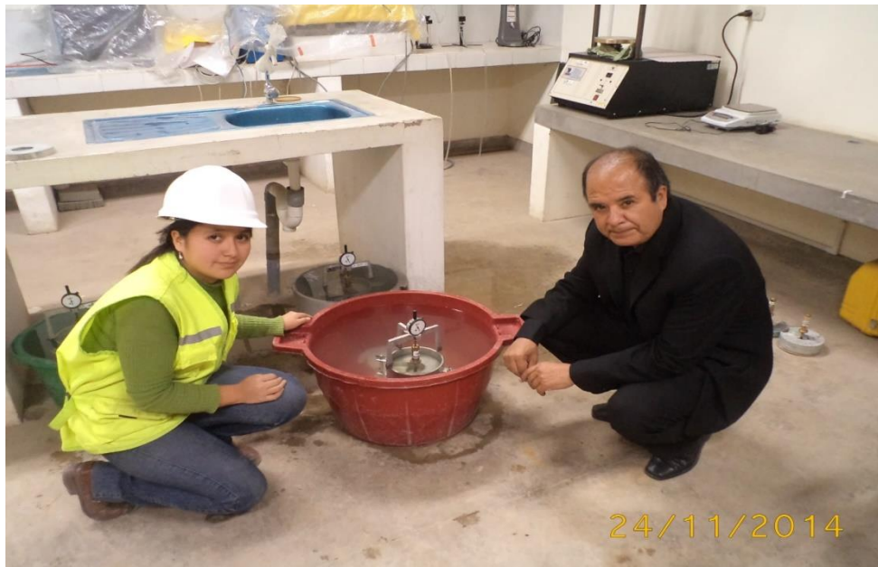
FOTO 28: lectura de la deformación de la muestra en el ensayo de CBR de hinchamiento
