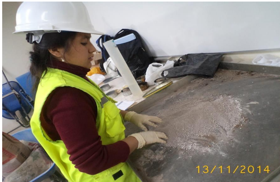
FOTO 16: mezclando suelo con cal para el proctor modificado
