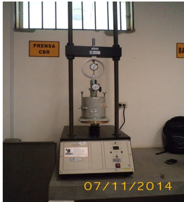
FOTO 31: Ensayo de penetración
