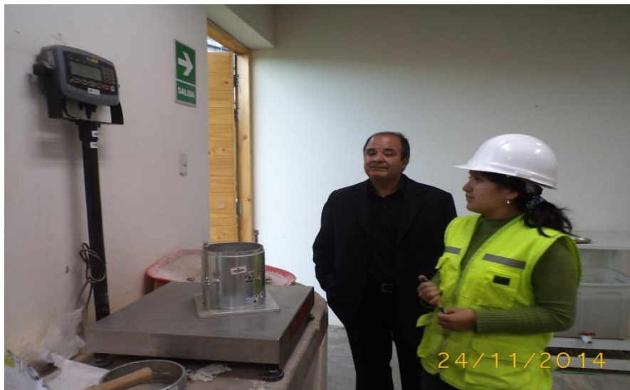
FOTO 26: lectura de peso del molde más muestra en el ensayo de CBR
