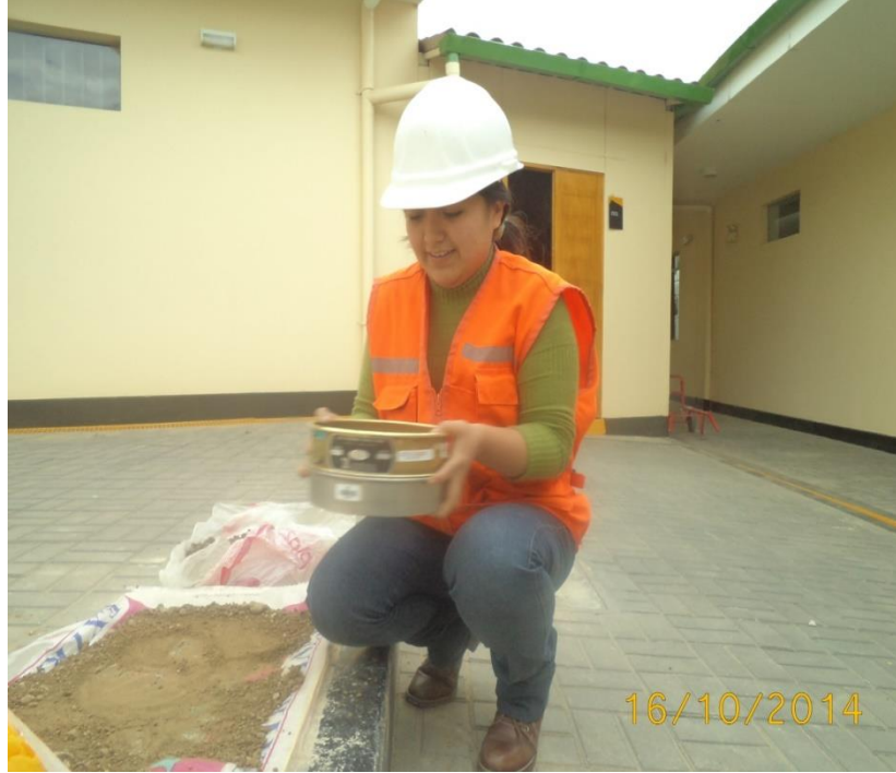
FOTO 09: Tamizando el material por la Nro. 40 para realizar el ensayo de los límites de Atterberg
