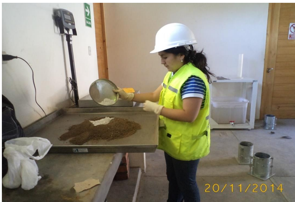
FOTO 22: mezclando la muestra de suelo con cal para el ensayo de CBR
