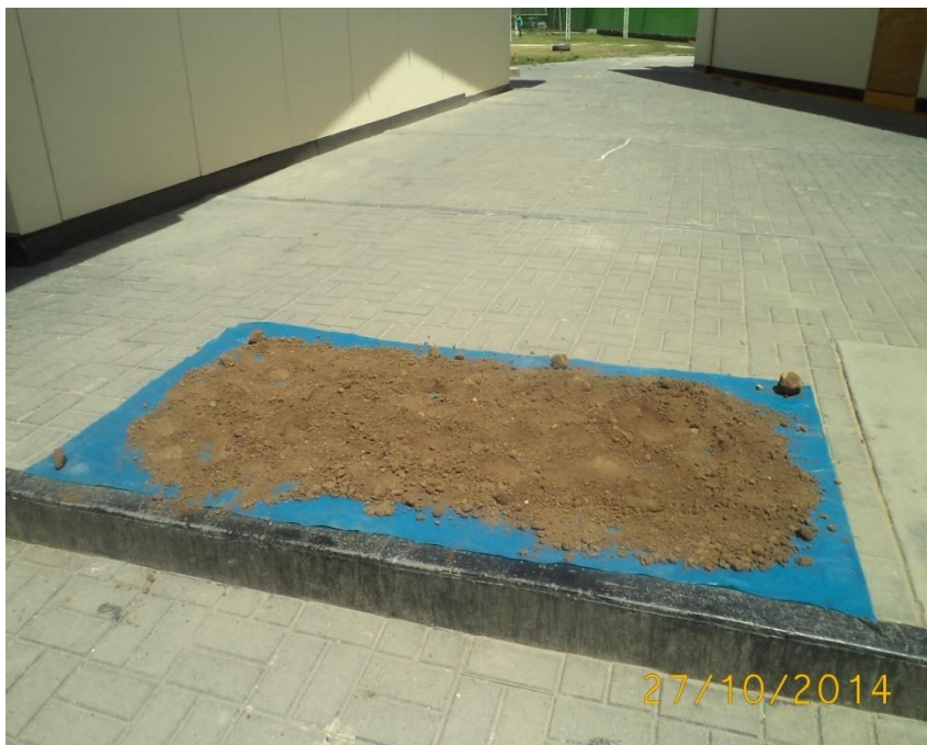
FOTO 06: Secando al aire la muestra obtenida de las calicatas
