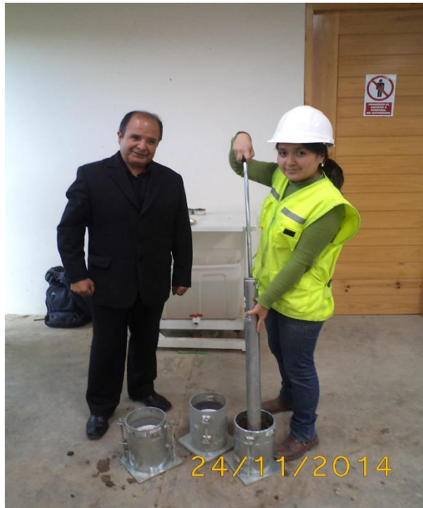
FOTO 23: realizando el ensayo de CBR junto a mi asesor
