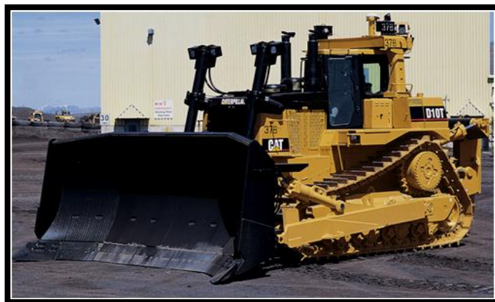
Fig. 2.15.- Tractor sobre oruga Fuente: Manual de rendimiento Hanbook Caterpillar.
