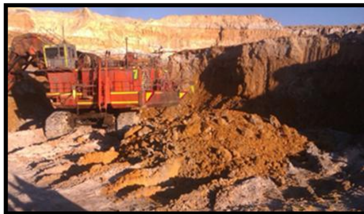
Figura 5.6.- Condición de piso de pala SH007
