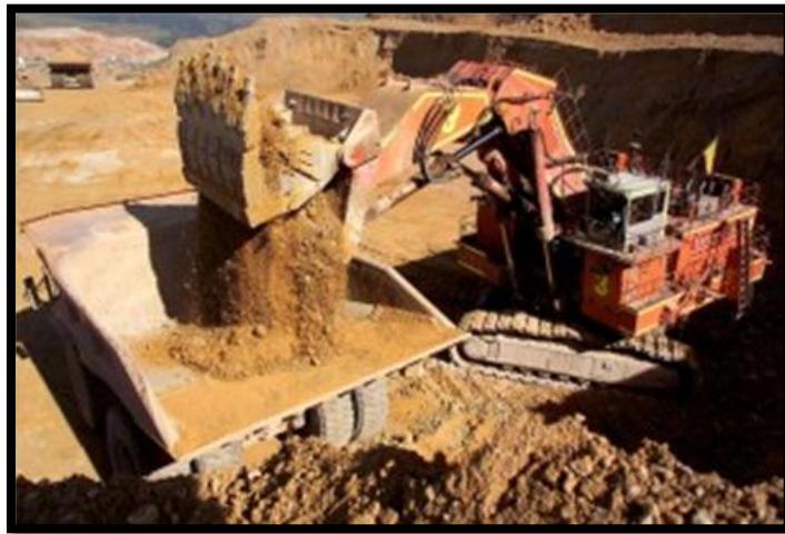
Fig. 5.2.- Carguío y acarreo de material minado
