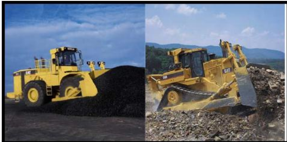
Fig. 2.13.- Tractores en operación. A la izquierda se muestra un modelo sobre ruedas y a la derecha, uno sobre orugas.
