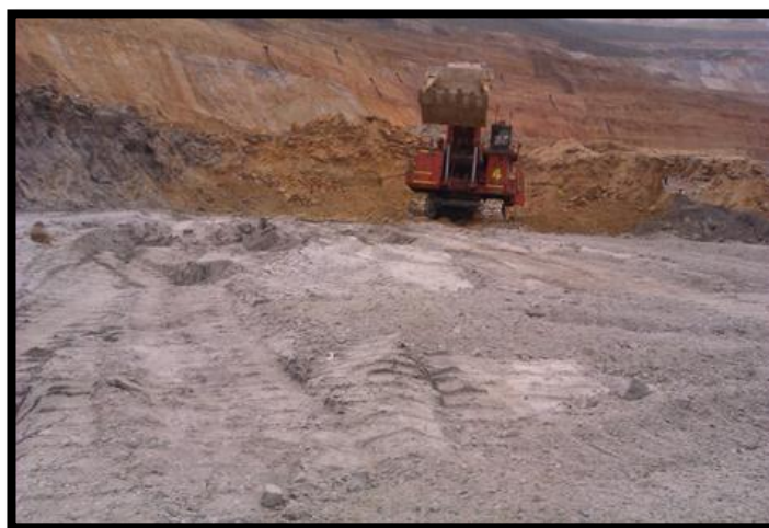
Fig. 5.8.- Material inestable del piso de pala
