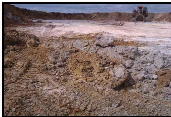
Fig. 5.15.- Piso muestra la arcilla (barro), que hace inestable al piso de carguío
