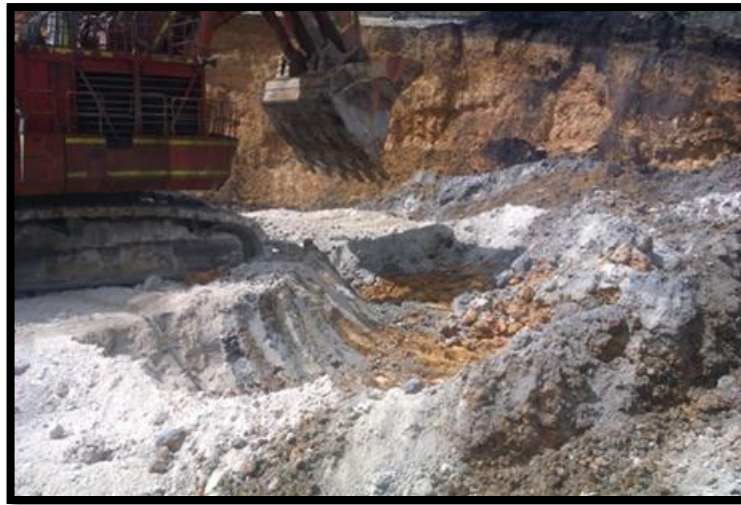
Figura 5.4.- Condición de piso de pala SH004.
