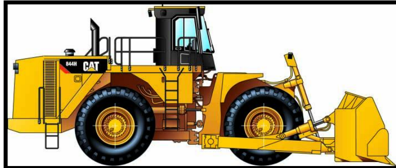
Fig. 2.14.-Tractor sobre ruedas. Fuente: Manual de rendimiento Hanbook Caterpillar.
