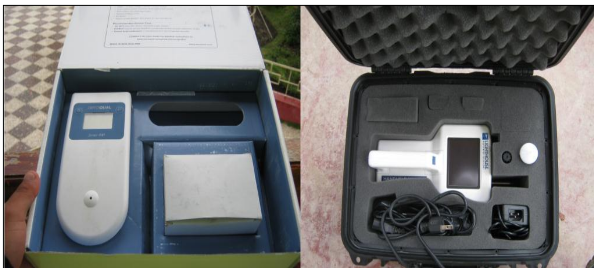
Foto 3: A la derecha, Equipo de Monitoreo de Partículas de PM10 y PM2.5, y a la izquierda Equipo de Monitoreo de Gases (Monóxido de Carbono, Dióxido de Azufre y Dióxido de Nitrógeno).
