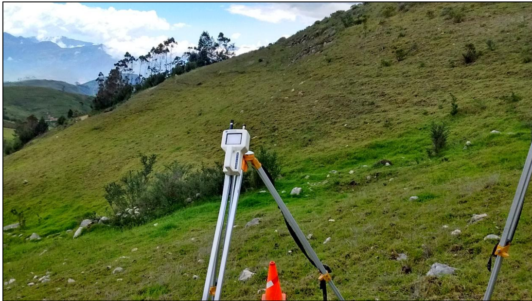
Foto 11: Equipo contador de partículas.
