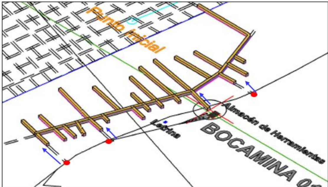
Imagen 6: Ventilación en la labor 1.
