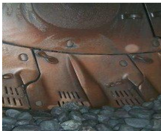
Figura 16: Parrilla de descarga con elevador tipo cuchara
