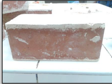
Figura N° 41. Preparación de las unidades enteras de albañilería para el ensayo de compresión.
