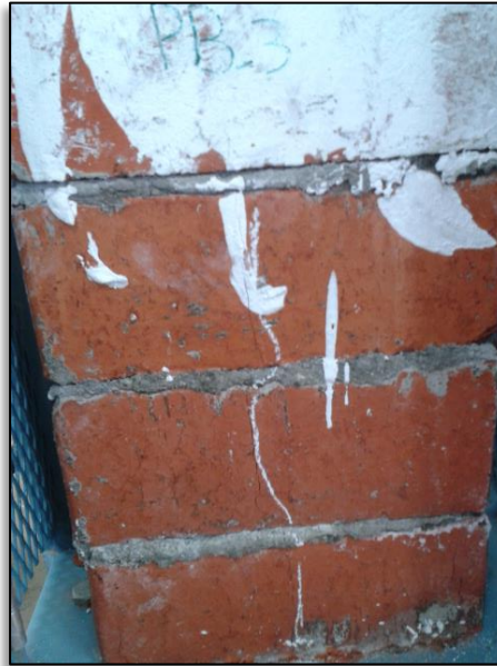
Figura N° 24. Falla de la pila PB-3. Parte posterior
