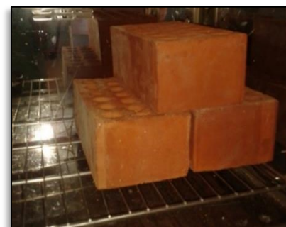
Figura N° 36. Ladrillos secos al horno a una temperatura de 110°C por 24 horas.
