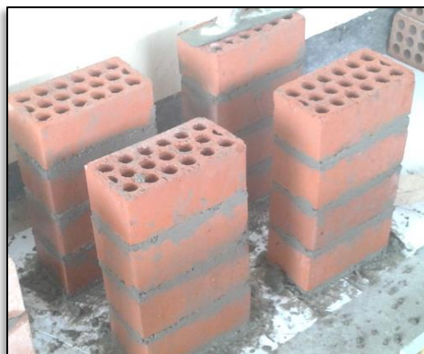
Figura N° 51. Pilas curadas después de tres horas de construidas
