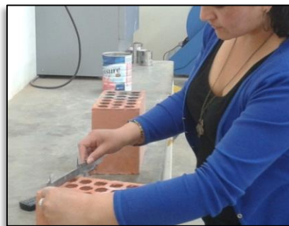
Figura N° 34. Medición de dimensiones usando el vernier.
