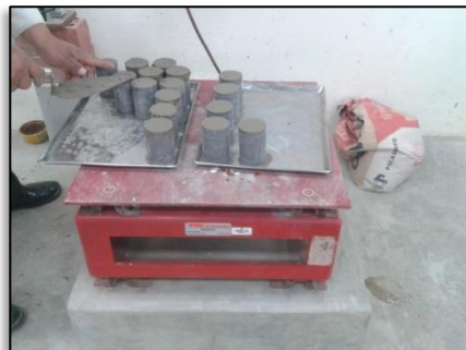
Figura N° 46. Compactado y Vibrado de cubos de mortero.
