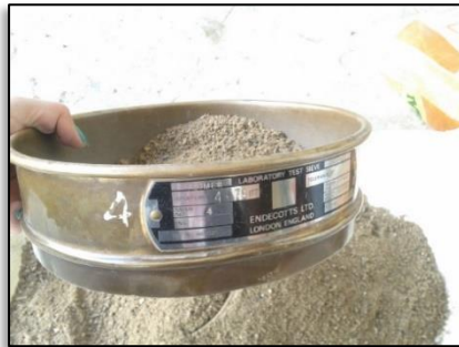
Figura N° 43. Uso del Tamiz N° 4 para la selección de arena.
