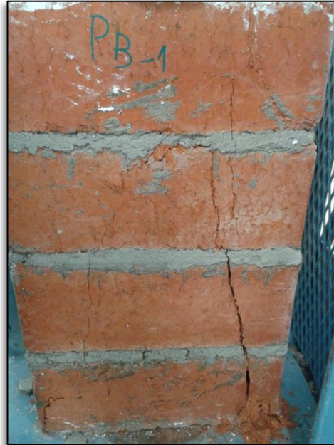
Figura N° 20. Falla de la pila PB-1, parte posterior.
