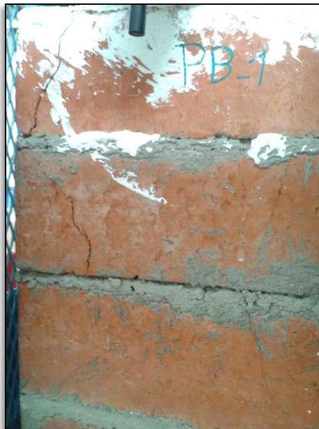
Figura N° 20. Falla de la pila PB-1, parte posterior.
