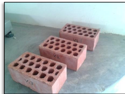
Figura N° 35. Unidades analizadas con Concavidad y Convexidad nula.
