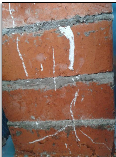
Figura N° 24. Falla de la pila PB-3. Parte posterior
