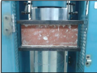
Figura N° 42. Muestra entera colocada en la máquina de ensayo.
