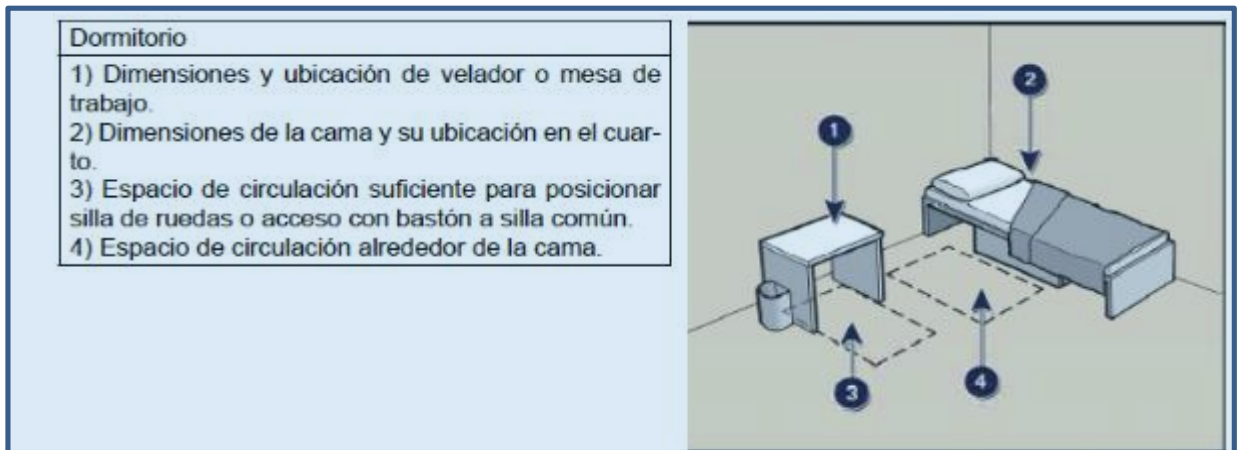
IMAGEN N° 15 DIMENSIONES ERGONOMÉTRICAS DE UN DORMITORIO
