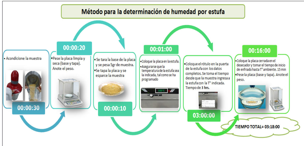
Figura n.º 4-1. Evaluación de tiempo en el método de determinación de humedad en estufa
